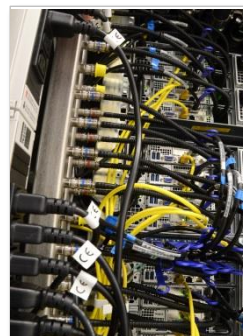
Rückseite mit 1GB- sowie 56GB/s-Netzwerk und DCLC-Leitungen...
